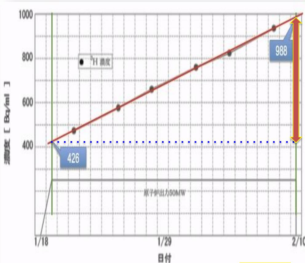
図 136 JMTR1次冷却水中のトリチウム濃度 (JMTR 第143 サイクル 2002.1.18~2.10)
